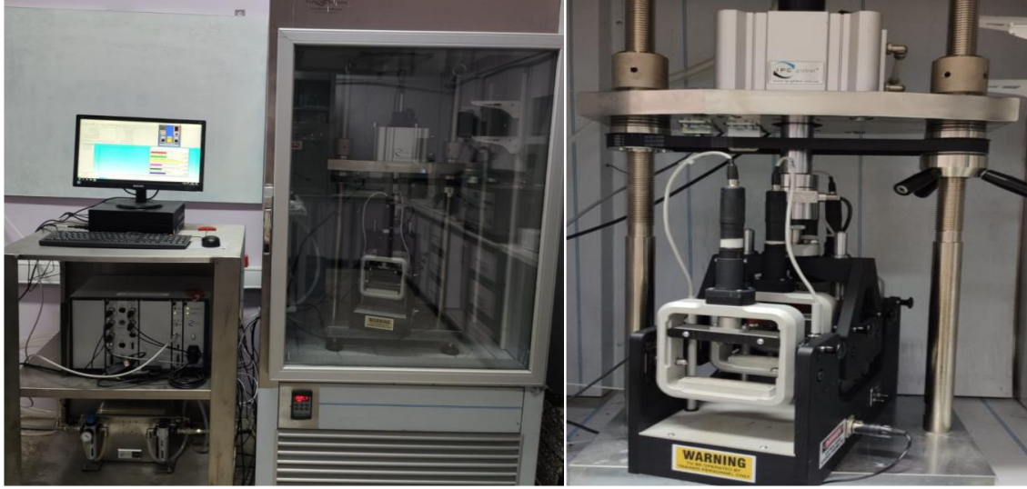
4 Noktalı eğilme yorulma deney ekipmanları ve yükleme aparatı
